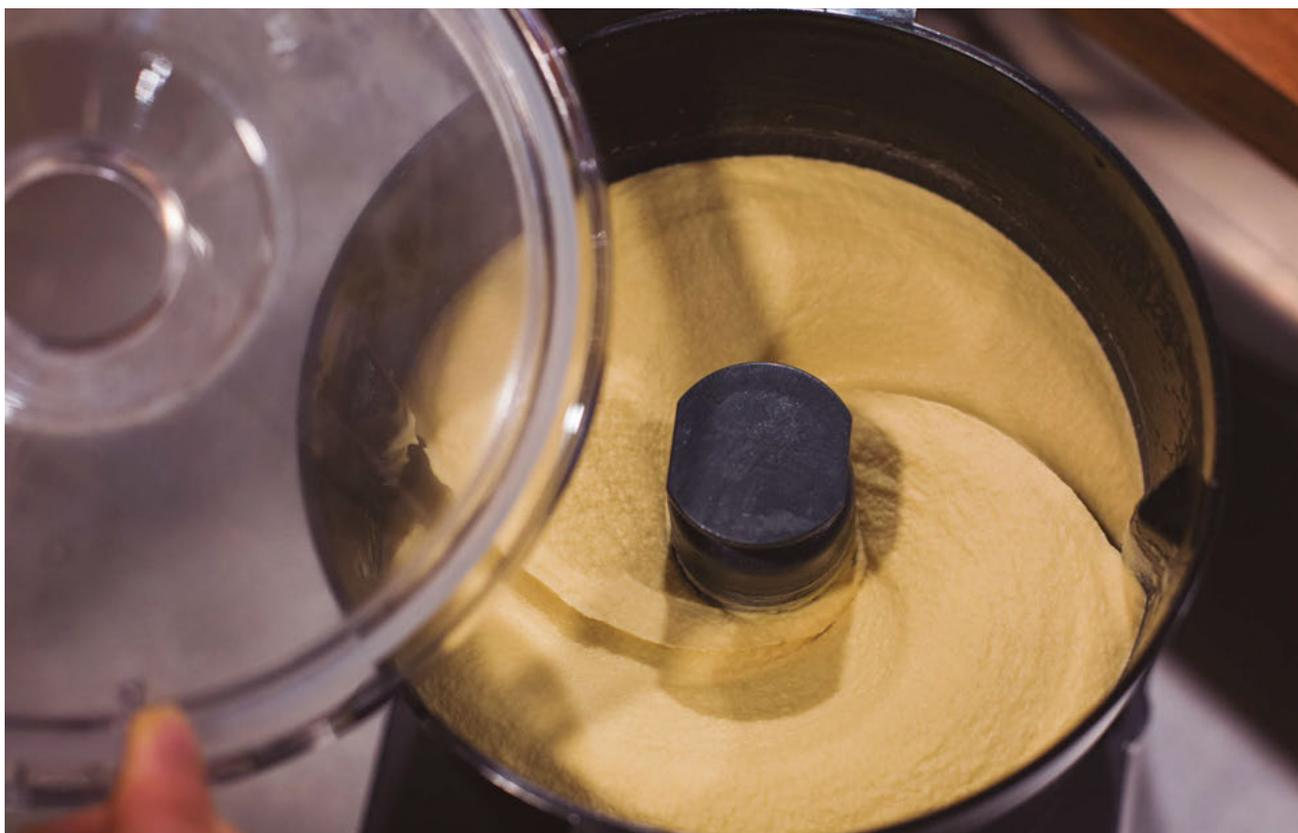
La Línea Compact presenta dos gamas de producto: Active, con velocidad fija y panel de mandos intuitivo, y Ultra, con motor brushless, velocidad variable y panel de mandos digital con pantalla LCD a color, ofreciendo prestaciones avanzadas y un control máximo del proceso en curso. Ambas gamas ofrecen una producción horaria de 350 Kg como cortadora y cuentan con caldero de 4.4 lt como cutter.
