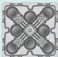
8 Columnas Ø 16,5 cm 40-48 platos/columna
