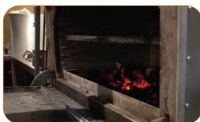
Incorpora cajón recoge cenizas.
