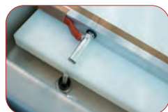
Barra de soldadura extraíble para facilitar limpieza.
