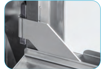
Nuevas bisagras que aseguran una completa apertura de la puerta y una carga rápida de la máquina
